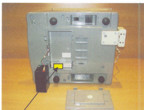
Zaštitni žig u obliku naljepnice na poklopcu kalibracionog prekidača
